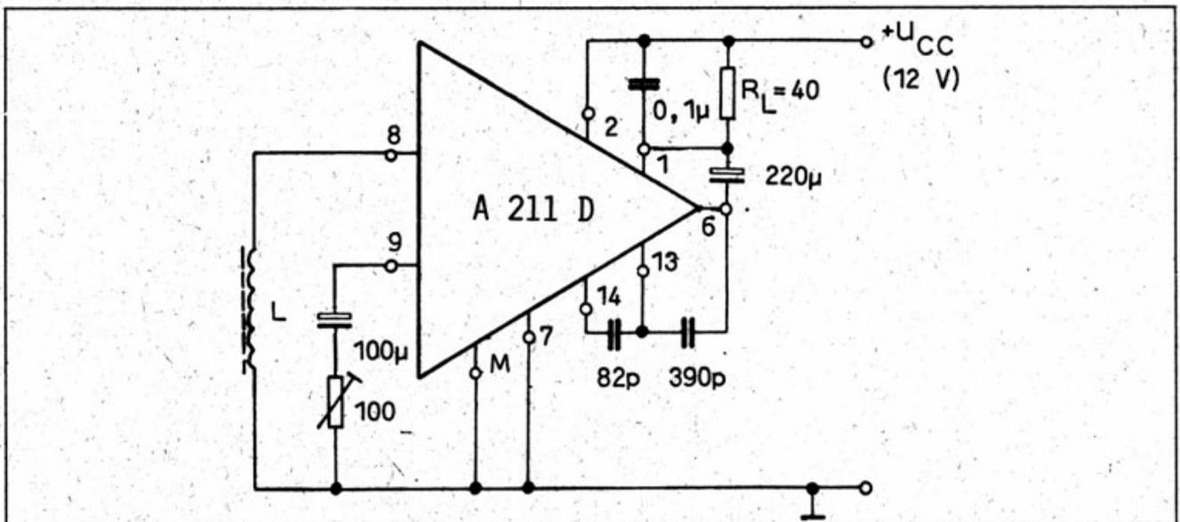
Applikationsbeispiel: Empfänger zur induktiven Übertragung von Signalen /7/
