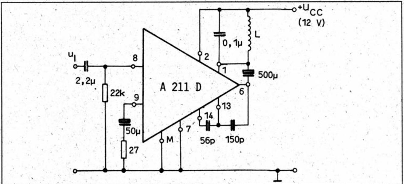
Applikationsbeispiel: Sender zur induktiven Übertragung von Signalen /7/
