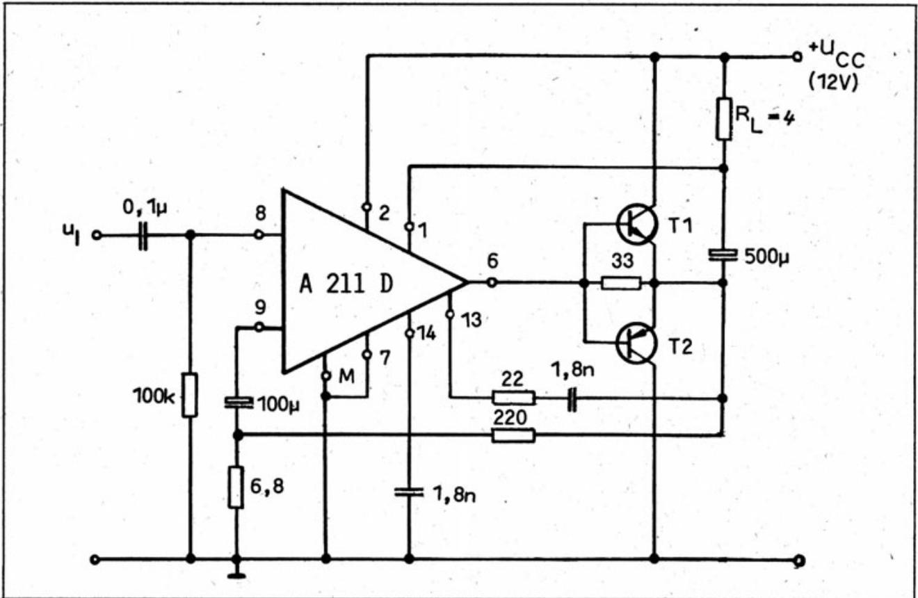
Applikationsbeispiel: NF-Verstärker mit Komplementär-Endstufe /7/, /11/
