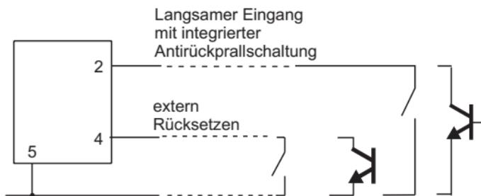
Für die Kontaktschliessung muss immer der langsame Eingang (Pin 2) verwendet werden, da er als einziger über Entprellschaltung verfügt.
