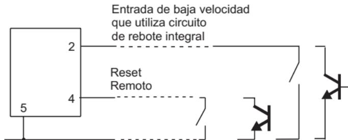
La entrada de baja velocidad (clavija 2) debe ser utilizada siempre para el cierre de contactos porque ésta es la única entrada que contiene circuitos antirebote.
