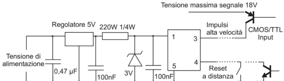
Montare il condensatore 100nF (soppressione di transienti) il più possibile vicino all'unità.
