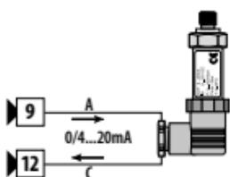
**Pour des signaux standard en courant 0/4..20mA avec capteur à deux fils**
