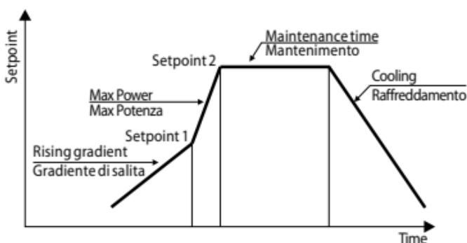
Lo Start del ciclo avviene al ogni accensione dello strumento, oppure da ingresso digitale se risulta abilitato questo tipo di funzionamento (parametro 94 *d..IF*, o 101 *d..2F* impostato come *St./St.* oppure *RuM*).
