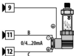
**Pour des signaux standard en courant 0/4..20mA avec capteur à trois fils**
