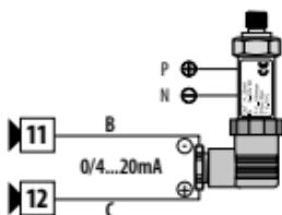
**Pour des signaux standard en courant 0/4..20mA avec capteur alimentation externe**
