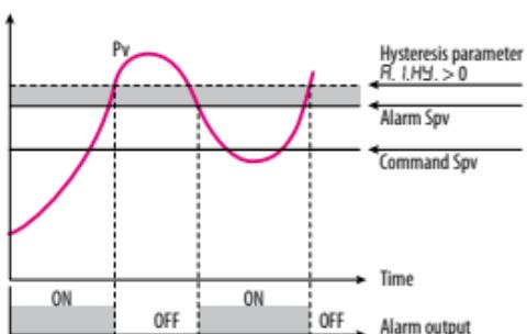
Allarme di deviazione inferiore valore di setpoint allarme minore di "0" e valore di isteresi maggiore di "0" (Par. 64 R.I.HY > 0).
