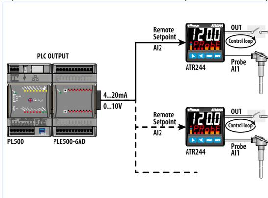
In questo esempio il setpoint di comando viene letto sul secondo ingresso analogico AI2: su par. 55  $c.Pr.2$  si imposta l'ingresso che determina il setpoint. La funzione Setpoint Remoto è attiva solo impostando  $R_{in.1}$  o  $R_{in.2}$  su par. 55  $c.Pr.2$
