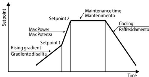
Lo Start del ciclo avviene ad ogni accensione dello strumento, oppure da ingresso digitale se risulta abilitato questo tipo di funzionamento (parametri 231, 239, 247, 255 impostati come  $5E.5E$  oppure  $RUN$ ).
