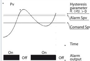
Allarme di deviazione inferiore valore di setpoint allarme minore di "0" e valore di isteresi maggiore di "0" (Par. 58  $R.I.H.Y. > 0$ ).
