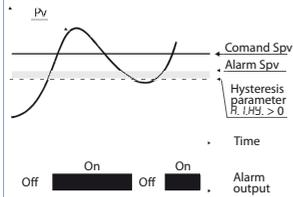
Allarme di deviazione superiore valore di setpoint allarme minore di "0" e valore di isteresi maggiore di "0" (Par. 58  $R.I.H.Y. > 0$ ).
