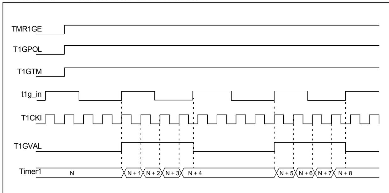
FIGURE 19-5: TIMER1 GATE SINGLE-PULSE MODE
