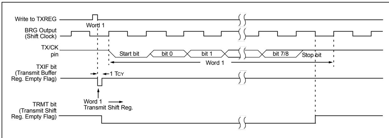
**FIGURE 21-4: ASYNCHRONOUS TRANSMISSION (BACK-TO-BACK)**
