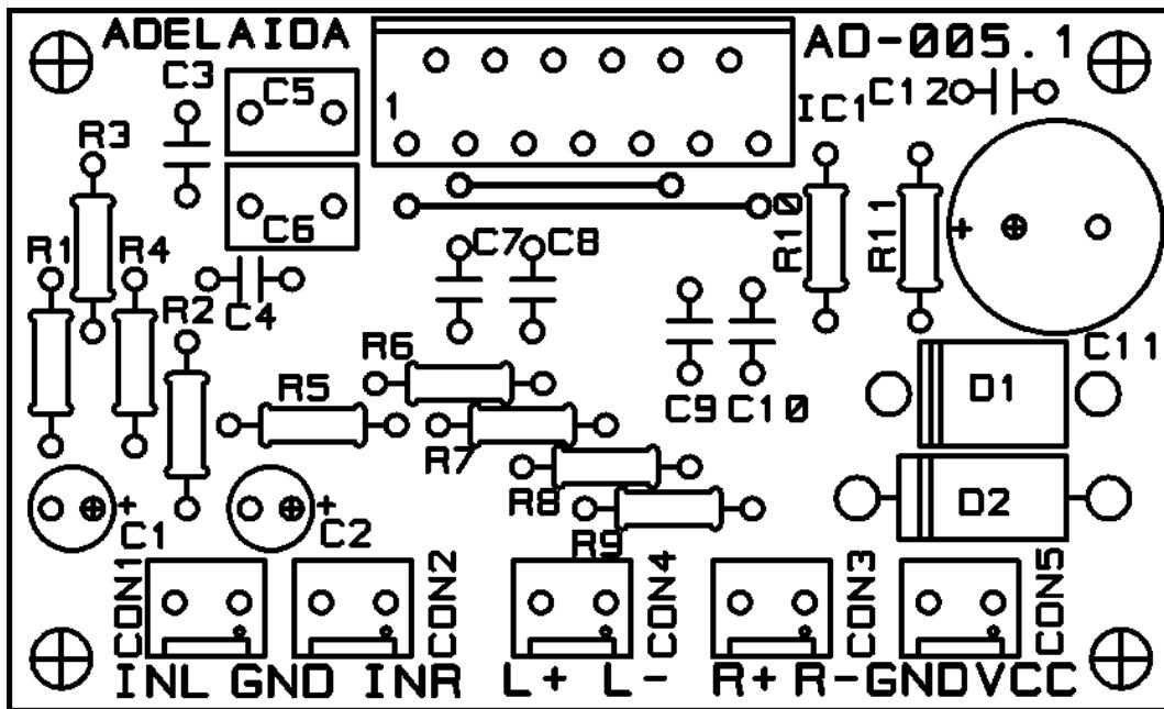
Montajul functioneaza corect daca se respecta conditiile privind nivelul semnalului de intrare , filtrajul corespunzator al sursei de alimentare , legarea corecta a difuzoarelor si folosirea unui radiator corespunzator pentru circuitul integrat TDA8560Q .
